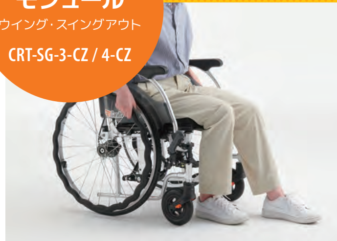
低座面+スイングアウト：フット・レッグサポートを外して、足こぎ走行。
